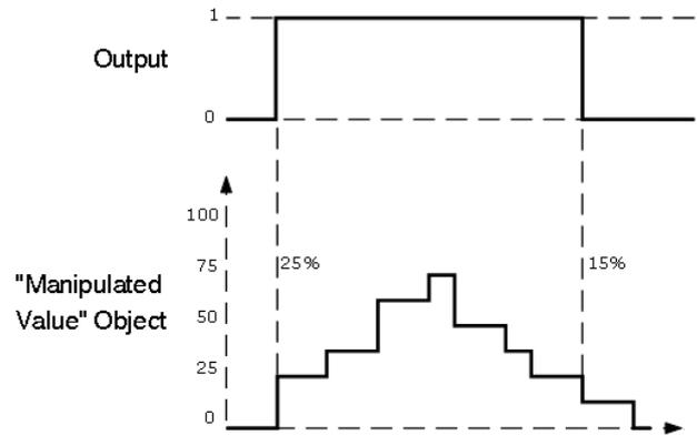
Fig12. Manipulated Value (1 Byte)
